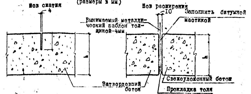
КОНСТРУКЦИИ ШВОВ (размеры в мм)
