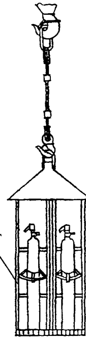
Строп 1СК-2,5 Q = 2,5 тс при подаче контейнера для хранения баллонов P = 750 кг
