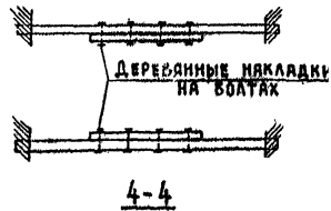
Усиление балок в середине пролета
