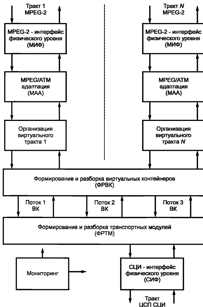
Рисунок 4.2 — Функциональная архитектура аппаратуры преобразования MPEG → СЦИ и СЦИ → MPEG
