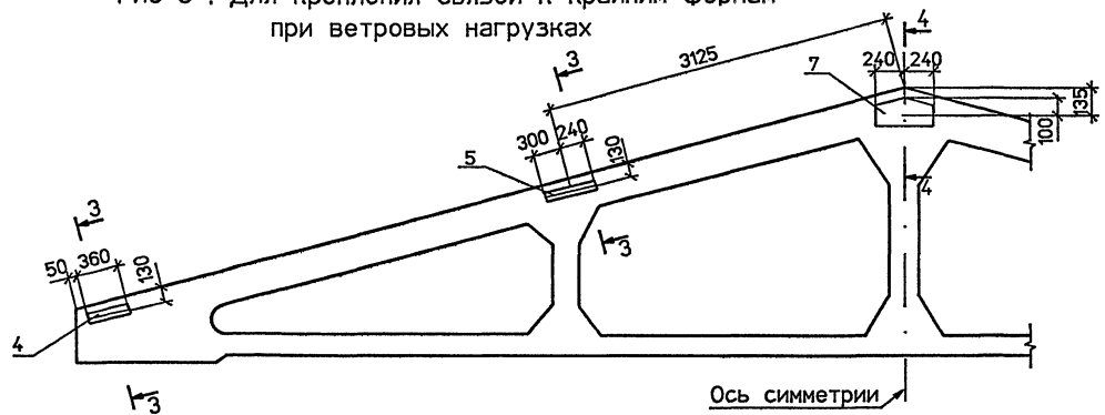
Рис 6 . Для крепления связей к средним фермам при ветровых нагрузках
