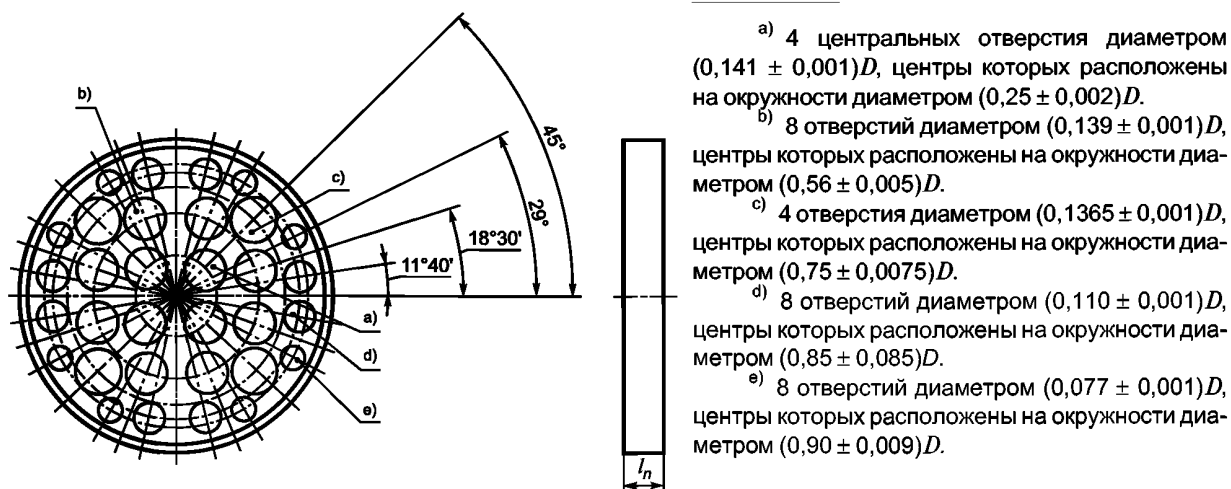
Рисунок Е.10 — Схема дискового УПП «Zanker»
