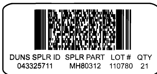
Рисунок 7 — Пример этикетки с символом PDF417 для идентификаторов данных DI (без учета масштаба)
