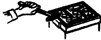
Рис.11.12. Проверка прочности соединения штыря баретки с выводными клеммами
