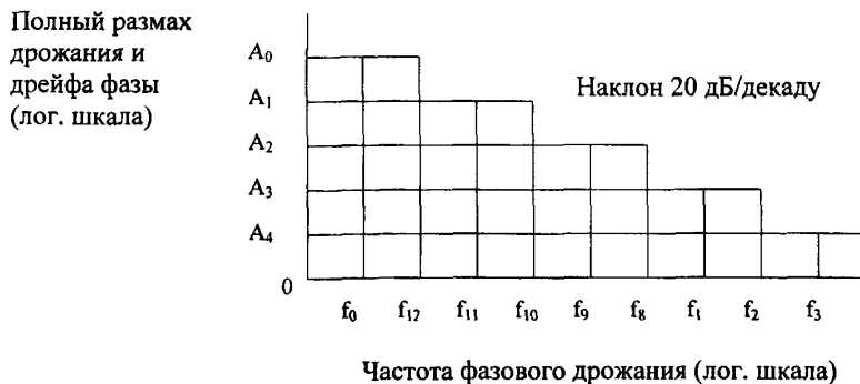
Рисунок Д.9 - Шаблон и значения параметров допусков на максимальное допустимое входное дрожание и дрейф фазы для аппаратуры радиорелейных систем синхронной цифровой иерархии
