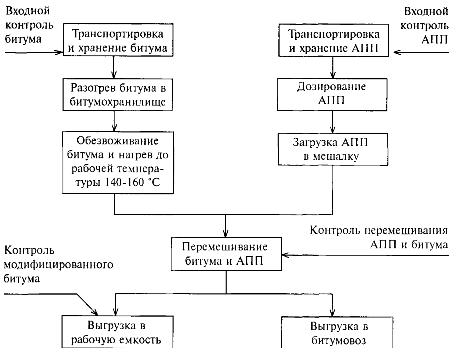
Рис. 8. Технологическая схема процесса приготовления битума, модифицированного АПП
