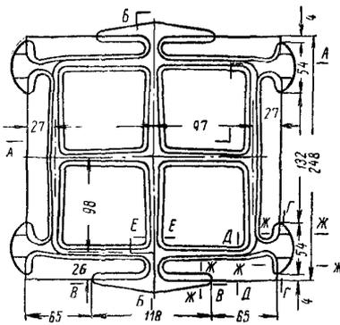
Рис. 7. Плита чугунная с опорными выступами для полов, укладываемая на песке. Общий вид. Вес плиты: гладкой 6,9 кг, рифленой 7,1 кг
