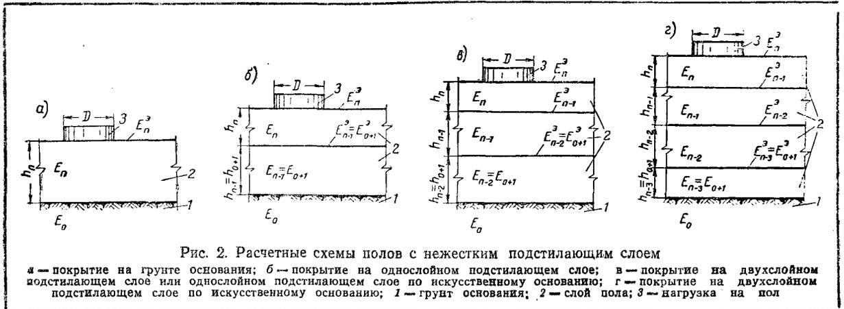
Рис. 2. Расчетные схемы полов с нежестким подстилающим слоем
