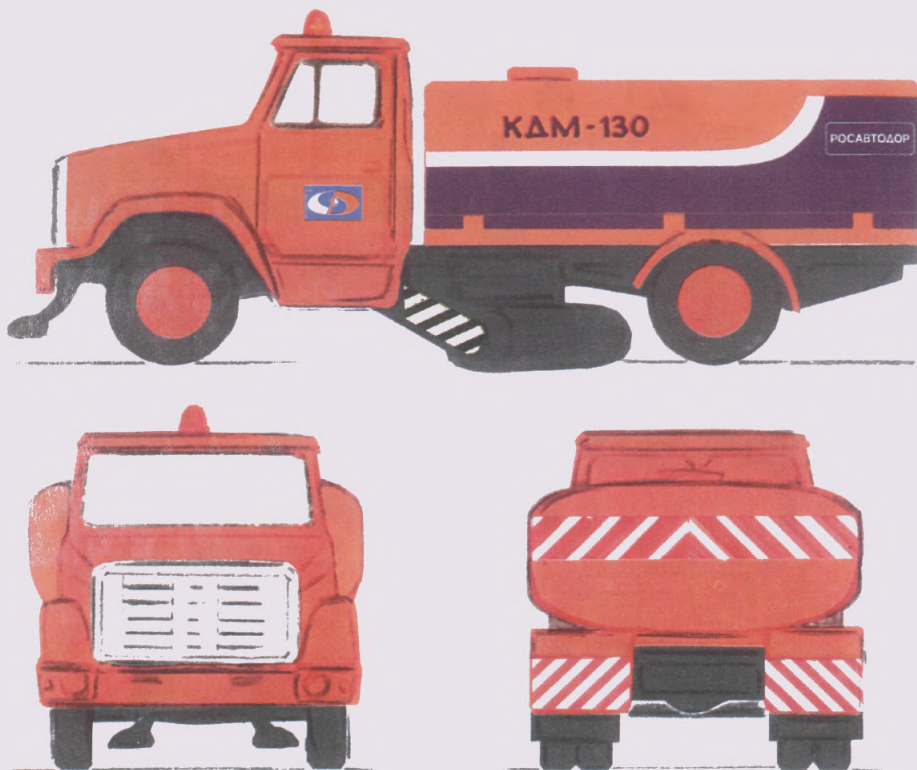
Рисунок Б.10 - Комбинированная дорожная машина на автомобильном шасси ЗИЛ (летний вариант)
