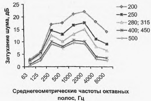
Затухание шума в круглых трубчатых глушителях, дБ, на 1 м длины
