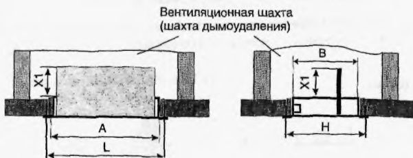
Установка клапана в перекрытии или подвесном потолке
