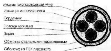
Схема кабеля П-296
