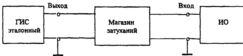
Рисунок 10 - Схема проверки измерения ошибок ИО
