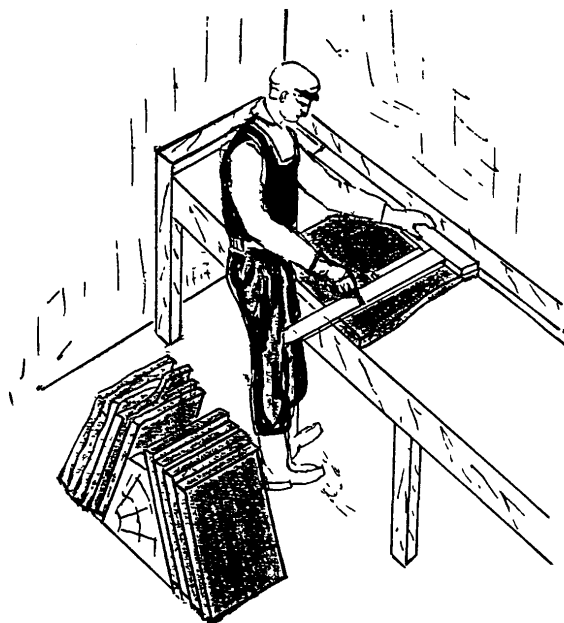
Рисунок 6 – Сортировка мраморных плит и проверка их геометрической формы
