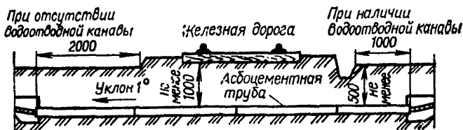
Рис. 3.2.2. Пересечение кабельной линией железной дороги.
