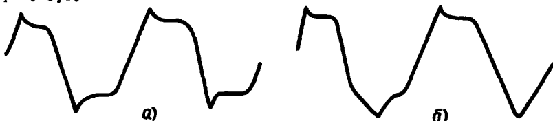
Рис.6. Форма кривой напряжения на стабилизаторах органа управления: а - при правильной полярности обоих стабилизаторов; б - при неправильной их полярности
