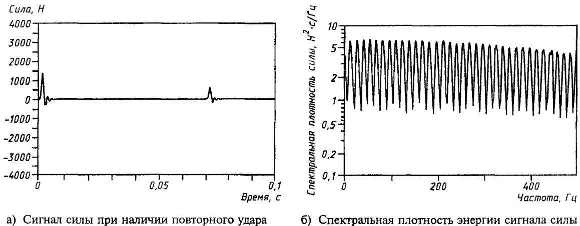
Рисунок 5 — Влияние повторного удара на спектр силы
