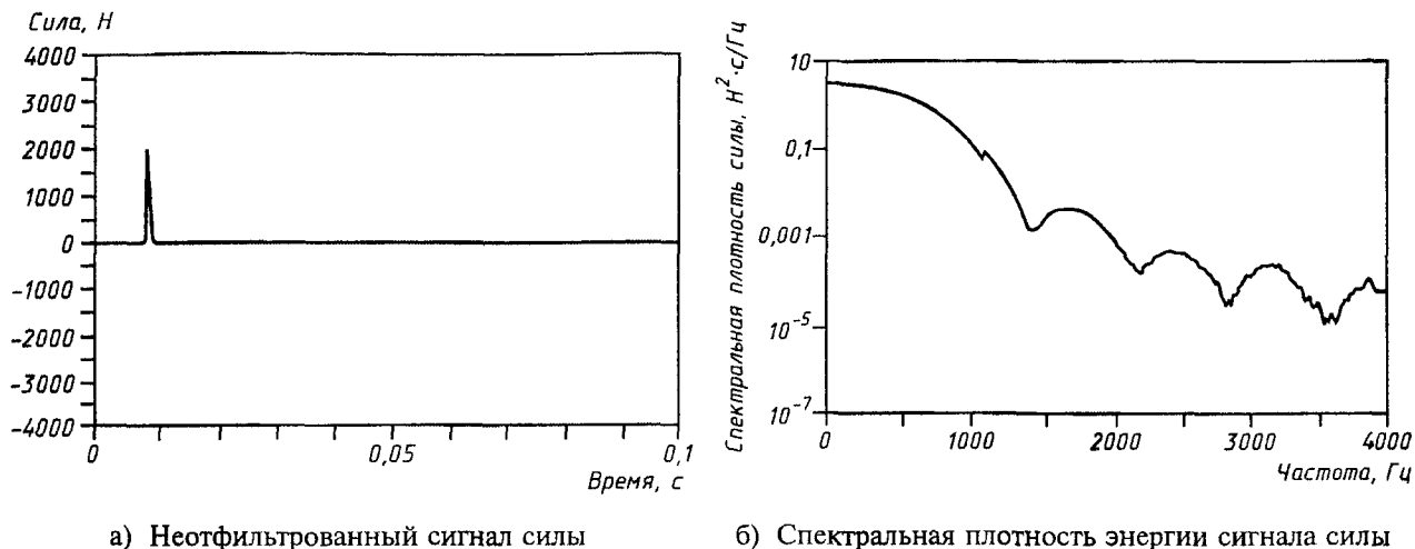
Рисунок 3 — Типичный импульс силы и его спектр
