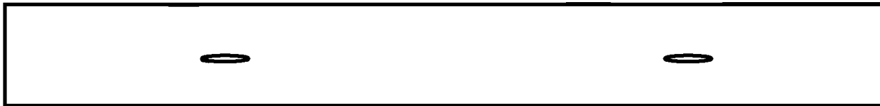
Пример 2 — две несплошности длиной по 6,4 мм
