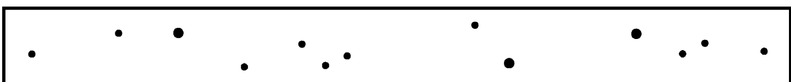
Пример 8 — три разбросанных несплошности диаметром по 0,8 мм; десять — по 0,4 мм
