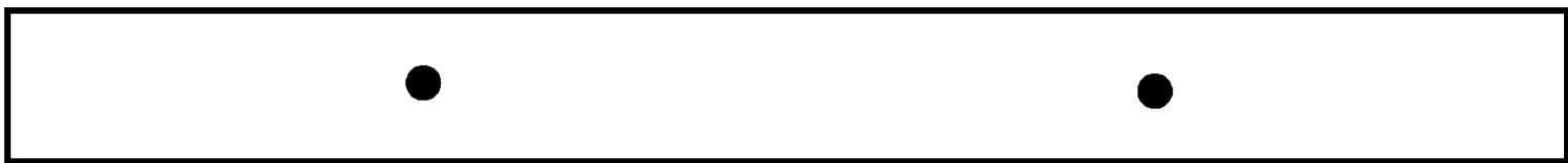
Пример 1 — две несплошности диаметром по 3,2 мм
