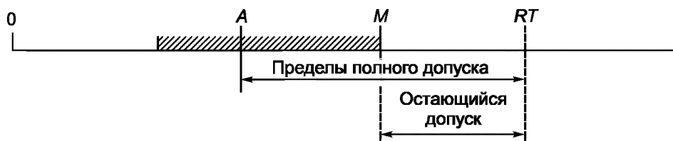
Рис. 5 — Принцип измерения декодируемости
