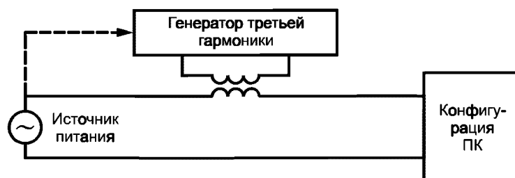
Рисунок 10 — Испытание на устойчивость к напряжению третьей гармоники
