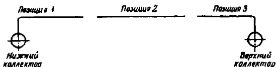
Рис. 2. Раскладка экранных труб перед стыковкой
