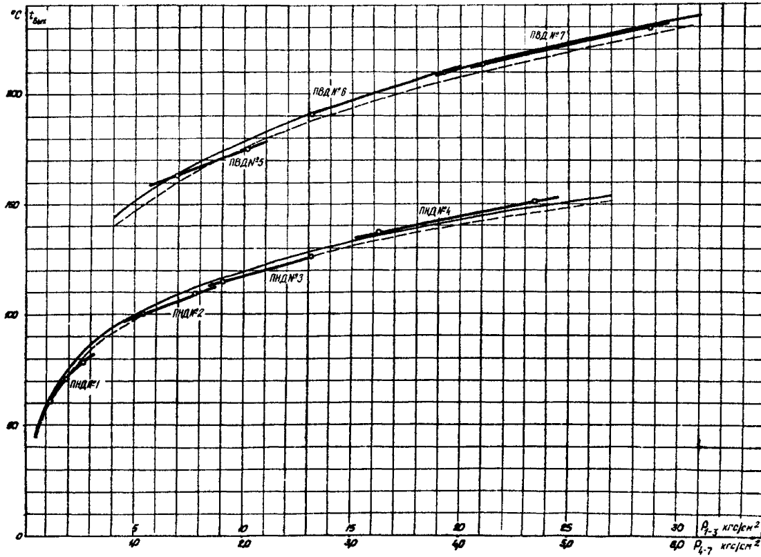
Рис.12. Зависимость температуры воды за подогревателями от давления в камерах отборов (на примере Минской ТЭЦ-3):
