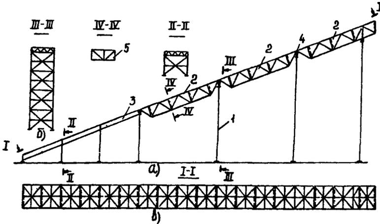
**Рис. 1. Пространственно-стержневая схема несущих металлоконструкций открытой эстакады топливоподачи:**
