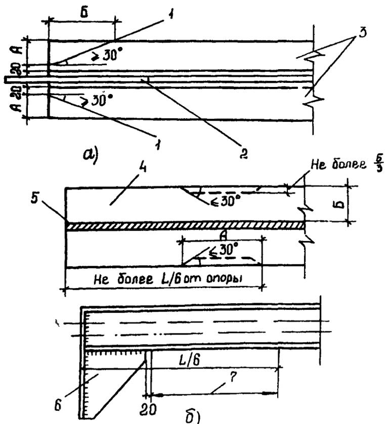
**Рис 4 Вырезки заготовок для анализа стали**
