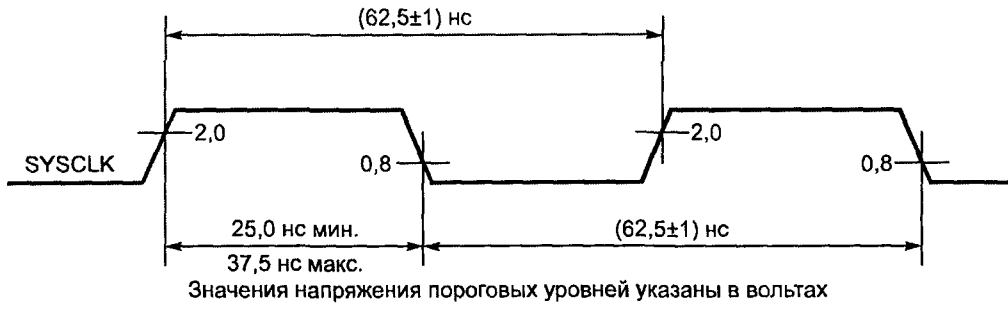
Рисунок 5.2 — Временная диаграмма работы формирователя системного тактового сигнала
