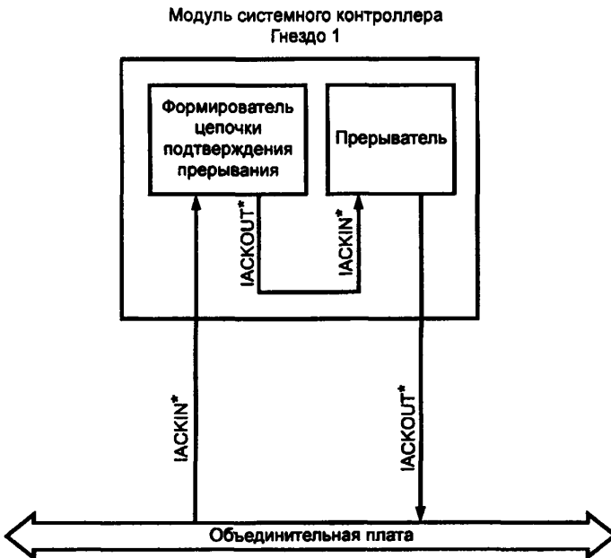
Рисунок 4.9 — Формирователь цепочки подтверждения прерывания и прерыватель в одном и том же модуле
