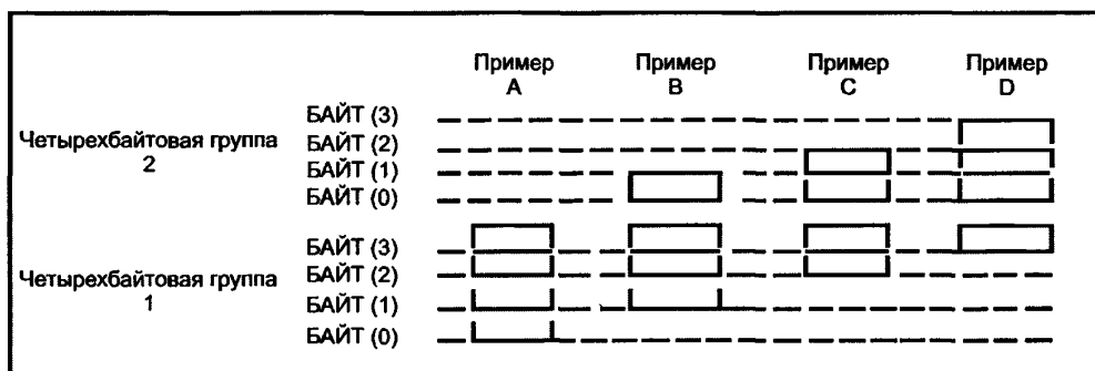
Рисунок 2.6 — Четыре способа размещения в памяти 32 разрядов данных
