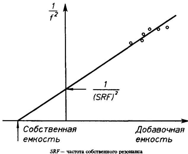
Рисунок 9 — Типичный график для определения собственной емкости
