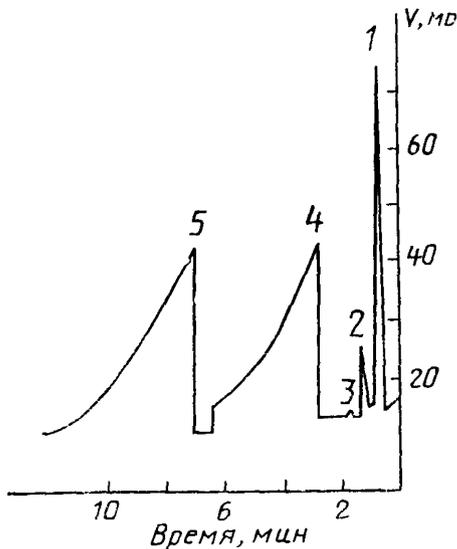
1—воздух; 2—двуокись углерода; 3—вода; 4—ацетальдегид; 5—окись этилена
