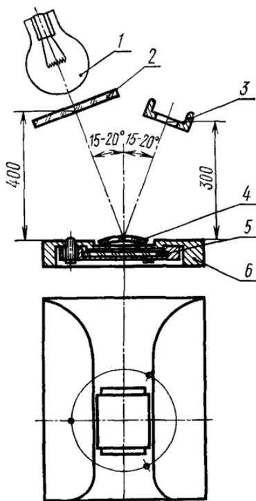
1—источник света; 2—кольцевая диафрагма; 3—диафрагма для фиксации положения глаза; 4—покровное стекло; 5—стеклянная пластина; 6—направляющие
