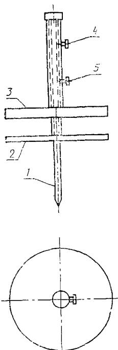
определяют толщину  $H_0$  с погрешностью не более 0,5 мм. После этого освобождают зажимной винт 4 и опускают диск 3, обеспечивающий совместно с диском 2 удельную нагрузку  $(2000 \pm 20)$  Па [ $(0,02 \pm 0,0002)$  кгс/см<sup>2</sup>]. Через 5 мин по линейке определяют толщину  $H_1$ .
