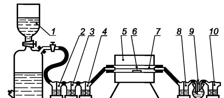
1 — газометр с кислородом или баллон с кислородом; 2, 3, 4 — очистительные склянки Тищенко; 5 — трубчатая печь; 6 — фарфоровая лодочка с анализируемым препаратом; 7 — трубка для сжигания; 8 — предохранительная склянка Тищенко; 9 — поглотительная колба; 10 — промывная склянка Тищенко
