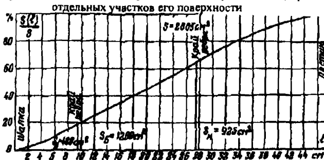
Рис.32. График для определения площади поверхности изолятора ПФ6-Б (чертеж И-3359) и площадей отдельных участков его поверхности
