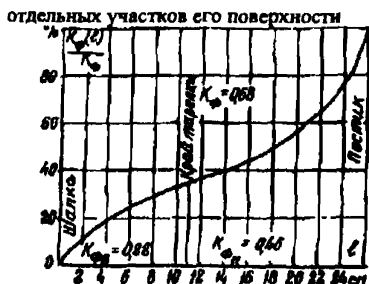
Рис.18. График для определения коэффициента формы изолятора ПС-А [ПС-4,5] (чертеж И-319) и коэффициентов формы отдельных участков его поверхности
