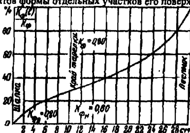
Рис.19 График для определения коэффициента формы изолятора ПС-Б (чертеж И-459) и коэффициентов формы отдельных участков его поверхности
