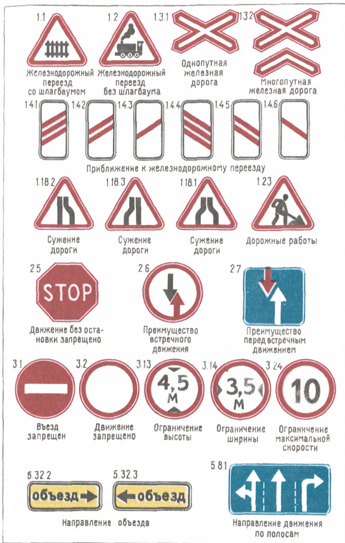
Рис. 1. Дорожные знаки и таблички, устанавливаемые на под- ходах к переездам, местам прогона скота и искусственным сооружениям (ГОСТ 10867—78 "Знаки дорожные")
