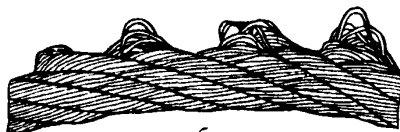
Рис. 12. Выдавливание проволок прядей: а — в одной пряди; б — в нескольких прядях
