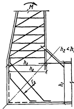
Рис. 8. Схема армирования угловых сопряжений массивных железобетонных конструкций
