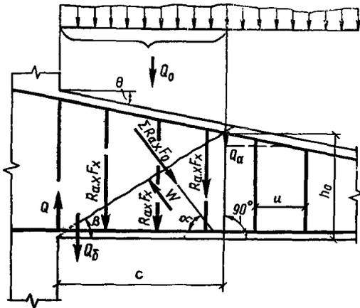
Рис. 6. Схема усилий в наклонном сечении элемента железобетонной конструкции с наклонной растянутой пранью при расчете его по прочности на действие поперечной силы
