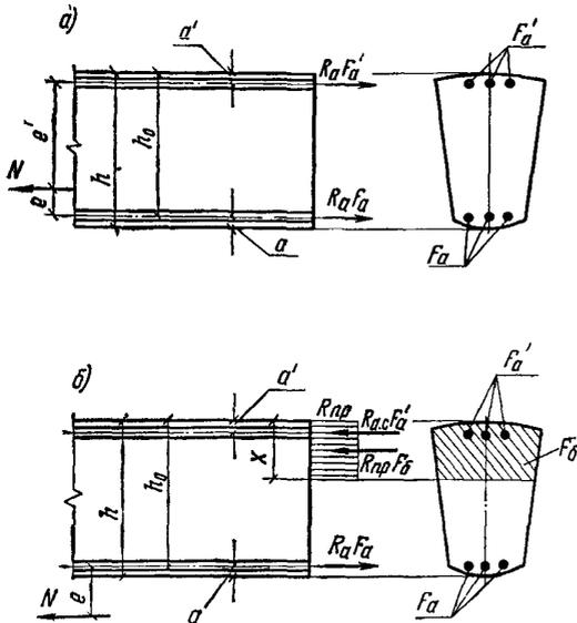
Рис. 4. Схема усилий и эпюра напряжений в сечении, нормальном к продольной оси внецентренно-растянутого железобетонного элемента, при расчете его по прочности
