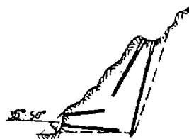
Рис. 5.7. Комбинированное расположение скважин на косогорах с уклоном 35-50^\circ
