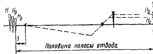
Рис 34 Схема установки кольев на обрезах с нанесением на них высотных отметок
