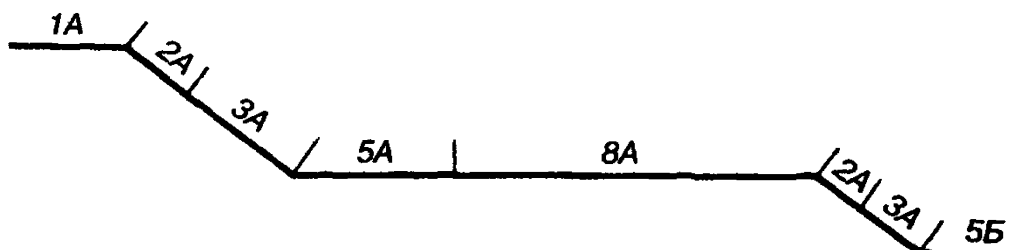
Рисунок А.5 — Схема расположения зон граничных условий на боковом откосе насыпи при наличии бермы для всех групп мостов
