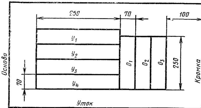
$U_1, U_2, U_3, U_4$  — заготовки уточных пробных полосок;  $O_1, O_2, O_3$  — заготовки основных пробных полосок
