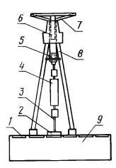
1 — облицовочная плитка; 2 — стальная пластинка; 3 — стержень; 4 — динамометр усилием 5 кН (500 кгс); 5 — шарнир; 6 — винт; 7 — маховое колесо; 8 — тренога; 9 — фрагмент конструкции
