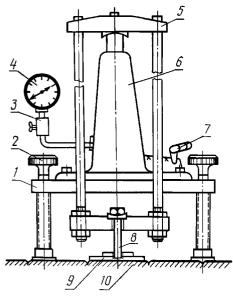
1— основание (плита); 2— регулировочные винты (опорные пяты); 3— защитный клапан; 4— манометр; 5— контурная (или силовая) рамка; 6— гидродомкрат усилием  $20~{\rm kH}$  ( $2~{\rm tc}$ ); 7— насос; 8— стержень захвата; 9— приклеиваемая стальная плита; 10— керамическая плитка
