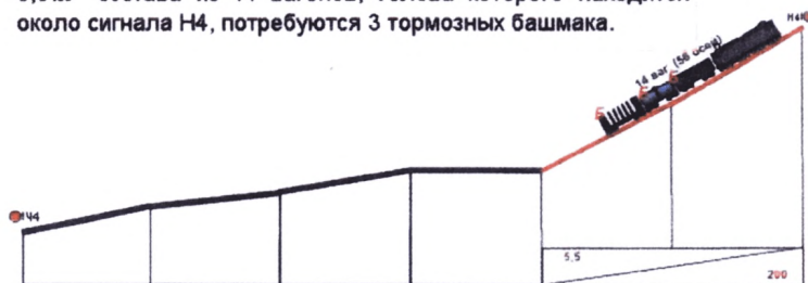
Рис.9.2. Закрепление состава остановленного со стороны чётной горловины станции.
