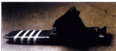
Рис. 8.14. Отсутствует ручка тормозного башмака.
