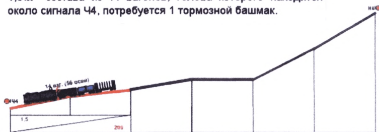
Рис.9.1. Закрепление состава остановленного со стороны нечётной горловины станции.
