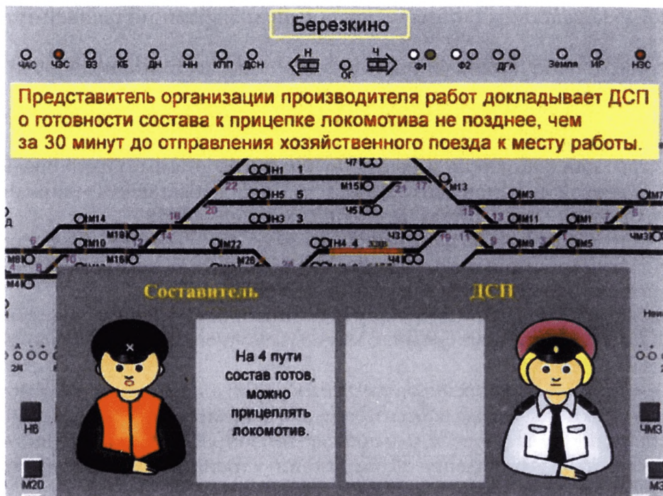
Рисунок 11.1. За 30 минут до отправления хозяйственных поездов представитель организации производителя работ докладывает о готовности состава к прицепке локомотива.
