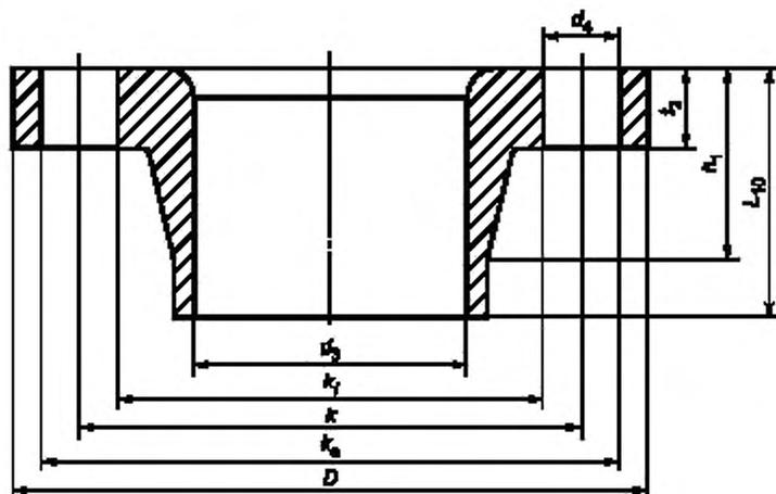
Рисунок 6 — Размеры фланцевой втулки
