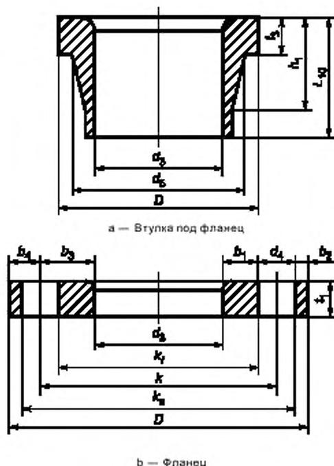
Рисунок 7 — Размеры втулки под фланец и фланца
