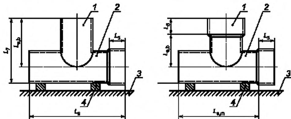
1 — отводной патрубок; 2 — основной патрубок; 3 — поворачивающая плита; 4 — подкладка
