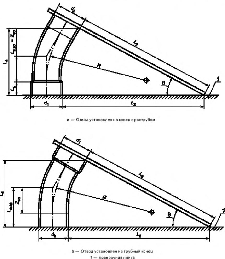
Рисунок 2 — Определение размеров отвода
