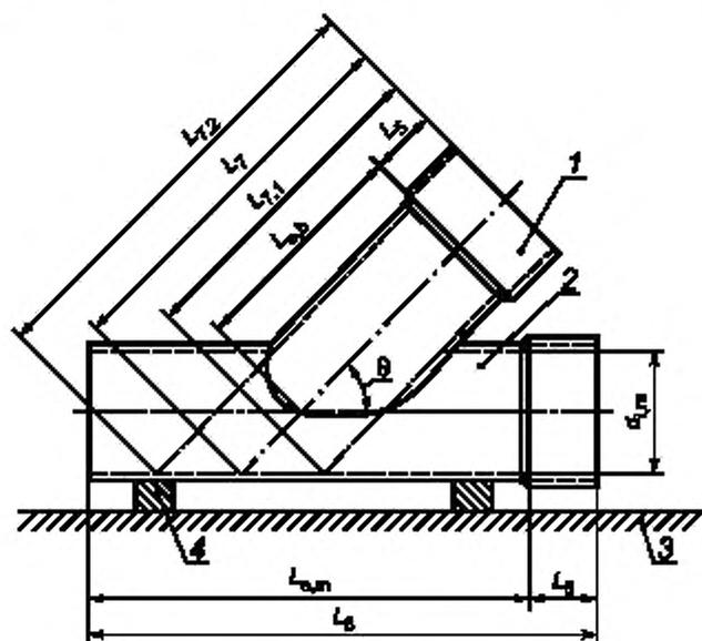
1 — отводной патрубок; 2 — основной патрубок; 3 — поворачивающая плита; 4 — подкладка
