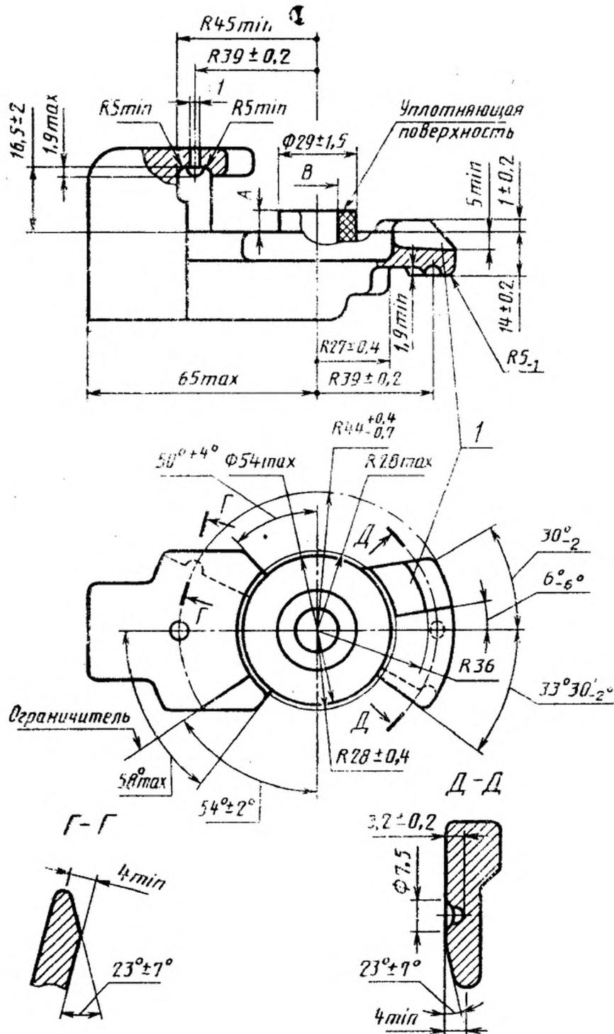
1 — предохранитель неправильного соединения
