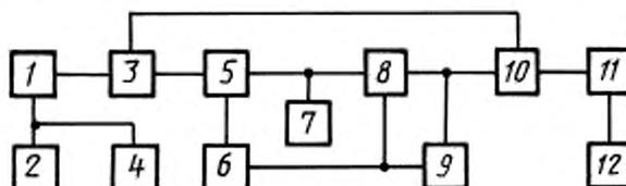
1 — образцовый излучатель; 2 — источник питания излучателя; 3 — световой затвор с устройством управления; 4 — вольтметр контроля напряжения питания образцового излучателя; 5 — прибор; 6 — синхрогенератор; 7 — резистор нагрузки или стабилизатор рабочего тока выходного транзистора прибора; 8 — усилитель; 9 — устройство отображения выходного сигнала; 10 — устройство измерения; 11 — ЭВМ; 12 — графопроектор.
