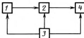
1 — устройство задания входного сигнала; 2 — прибор; 3 — синхрогенератор или блок задания электрического режима прибора; 4 — устройство обработки, отображения, измерения выходного сигнала прибора
