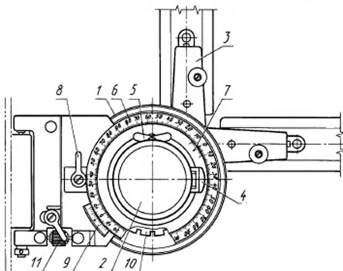
1 — чертежная головка; 2 — ручка; 3 — держатель масштабной линейки; 4 — рычаг фиксации стопорного диска; 5 — рычаг фиксации произвольного угла; 6 — основная шкала; 7 — нониус; 8 — рычаг фиксации дополнительного поворота; 9 — нониус дополнительного поворота; 10 — стопорный диск; 11 — регулятор точной настройки
