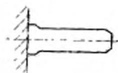
Электрическое соединение штыревого типа с контактными штырьками цилиндрической формы — контактный штырек цилиндрической формы
