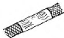
**Электрические соединения обжимного типа**
