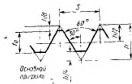
За основной профиль принимают профиль, имеющий предельные отклонения внутренней и наружной резьбы.
