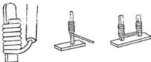
Электрические соединения с фиксацией провода
