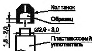
Рисунок Г.6 — Уплотнение образца в колпачке электрода
