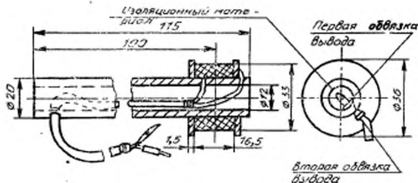
4500 витков медного эмалированного провода  $\phi 0,13$  мм  $N = 5000$  Ом.
