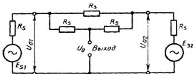
$E_{S1}$  и  $E_{S2}$  — ЭДС источников сигналов;  $R_S$  — номинальное выходное сопротивление источников сигналов
