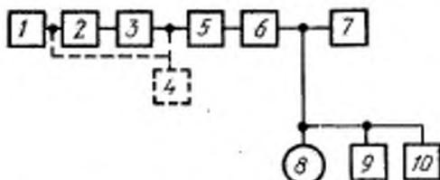
1 — генератор ГСН; 2 — цепь предуслаживаний; 3 — генератор ГСВ2; 4 — частотомер; 5 — эквивалент антенны; 6 — радиоприемник; 7 — эквивалент нагрузки; 8 — электронный вольтметр переменного тока; 9 — измеритель коэффициента гармоник или анализатор спектра; 10 — осциллограф
