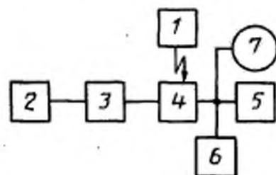
1 — генератор поля; 2 — генератор (ГСВ1 или ГСВ2); 3 — эквивалент антенны; 4 — радиоприемник; 5 — эквивалент нагрузки; 6 — осциллограф; 7 — электронный вольтметр переменного тока
