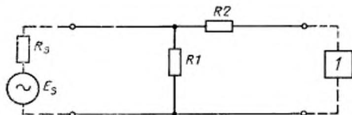
1 — радиоприемник;  $E_s$  — ЭДС источника сигнала;  $R_3$  — номинальное выходное сопротивление источника сигнала,  $R_1$ ,  $R_2$  — резисторы
