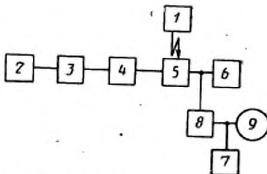
1 — генератор поля; 2 — генератор ГСВЧ; 3 — генератор ГСВЧ; 4 — эквивалент антенны; 5 — радиоприемник; 6 — эквивалент нагрузки; 7 — осциллограф; 8 — фильтр нижних частот; 9 — электронный вольтметр переменного тока
