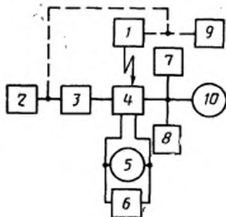
1 — генератор поля; 2 — генератор (ГСВ1 или ГСВ2); 3 — эквивалент антенны; 4 — радиоприемник; 5 — вольтметр переменного (постоянного) тока; 6 — источник постоянного (переменного) тока; 7 — осциллограф; 8 — эквивалент нагрузки; 9 — частотомер; 10 — электронный вольтметр переменного тока
