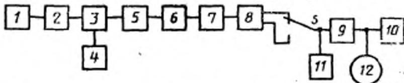
1 — генератор ГСН; 2 — стереофонический модулятор; 3 — смеситель; 4 — генератор ГНН; 5 — генератор ГСВ2; 6 — эквивалент антенны; 7 — радиоприемник; 8 — эквивалент нагрузки; 9 — полосовой фильтр с полосой пропускания на уровне минус 3 дБ от 200 Гц до 15 кГц; 10 — анализатор спектра; 11 — осциллограф; 12 — электронный вольтметр переменного тока; S — переключатель
