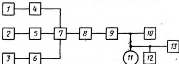
1, 2, 3 — генераторы ГСН; 4, 5, 6 — генераторы ГСВЧ; 7 — схема смешения сигналов; 8 — эквивалент антенны; 9 — радиоприемник; 10 — эквивалент нагрузки; 11 — электронный вольтметр переменного тока; 12 — анализатор спектра или селективный вольтметр; 13 — осциллограф
