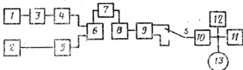
1, 2 — генераторы ГСН; 3 — стереофонический модулятор; 4, 5 — генератор ГСВ2; 6 — схема смешения сигналов; 7 — эквивалент антенны; 8 — радиоприемник; 9 — эквивалент нагрузки; 10 — полосовой фильтр с полосой пропускания на уровне минус 3 дБ от 200 Гц до 15 кГц; 11 — анализатор спектра; 12 — осциллограф; 13 — электронный вольтметр переменного тока; S — переключатель
