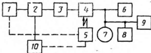
1 — генератор ГСН; 2 — генератор ГСВ4; 3 — эквивалент антенны; 4 — радиоприемник; 5 — генератор поля; 6 — эквивалент нагрузки; 7 — электронный вольтметр переменного тока; 8 — измеритель коэффициента гармоник или анализатор спектра; 9 — осциллограф; 10 — частотомер
