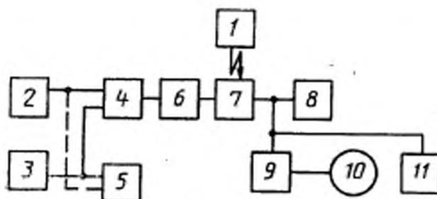
1 — генератор поля; 2, 3 — генераторы ГСВЧ; 4 — схема смешения сигналов; 5 — частотомер; 6 — эквивалент антенны; 7 — радиоприемник; 8 — эквивалент нагрузки; 9 — полосовой фильтр с полосой пропускания на уровне минус 3 дБ от 900 до 1100 Гц; 10 — вольтметр электронный переменного тока; 11 — осциллограф
