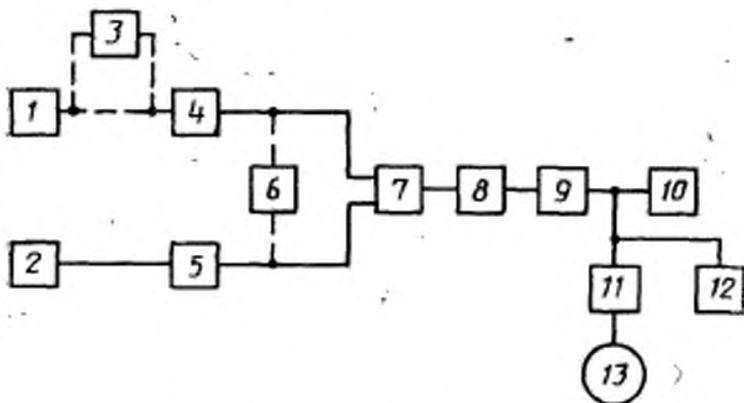
1, 2 — генераторы ГСН; 3 — стереофонический модулятор; 4, 5 — генераторы ГСВ2; 6 — частотомер; 7 — схема смещения сигнала; 8 — эквивалент антенны; 9 — радиоприемник; 10 — эквивалент нагрузки; 11 — полосовой фильтр с полосой пропускания на уровне минус 3 дБ от 900 до 1100 Гц; 12 — осциллограф; 13 — электронный вольтметр переменного тока
