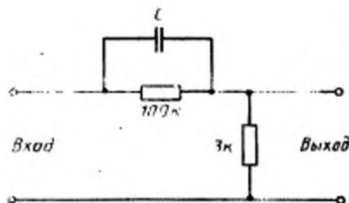
$C$  — конденсатор, емкостью 500 пФ ( $\tau=50$  нкс) или 750 пФ ( $\tau=75$  нкс). (Точное значение емкости подбирают при настройке цепи предискажений)
