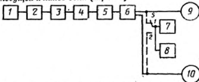
1 — генератор ГСН; 2 — стереофонический модулятор; 3 — генератор ГСВ2; 4 — эквивалент антенны; 5 — радиоприемник; 6 — эквивалент нагрузки; 7 — селективный вольтметр или анализатор спектра; 8 — осциллограф; 9, 10 — электронный вольтметр переменного тока; S — переключатель.
