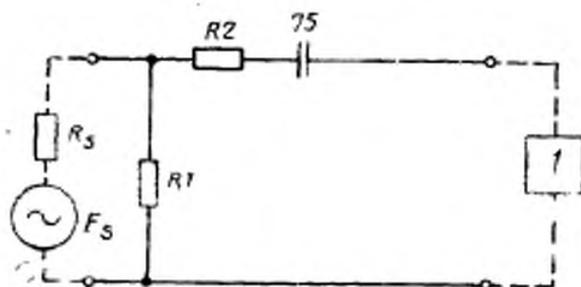
*I* — радиоприемник;  $E_s$  — ЭДС источника сигнала;  $R_s$  — номинальное выходное сопротивление источника сигнала;  $R_1$  — резистор сопротивлением, равным номинальному выходному сопротивлению источника сигнала;  $R_2$  — резистор сопротивлением,
