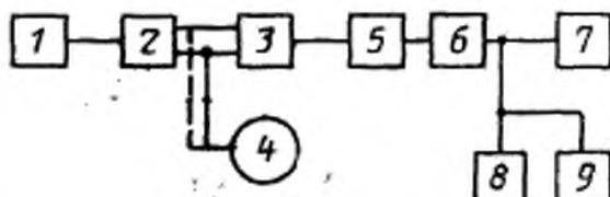
1 — генератор ГСН; 2 — измерительный стенд; 3 — схема смешения сигналов; 4 — электронный вольтметр переменного тока; 5 — эквивалент антенны; 6 — радиоприемник; 7 — эквивалент нагрузки; 8 — осциллограф; 9 — анализатор спектра
