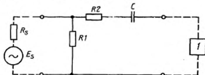
1 — радиоприемник;  $E_s$  — ЭДС источника сигнала;  $R_s$  — номинальное выходное сопротивление источника сигнала;  $R_1$  — резистор сопротивлением, равным номинальному выходному сопротивлению источника сигнала;  $R_2$  — резистор сопротивлением, определяемым из условия  $R_2 = (80 - \frac{R_s}{2})$  Ом;  $C$  — конденсатор
