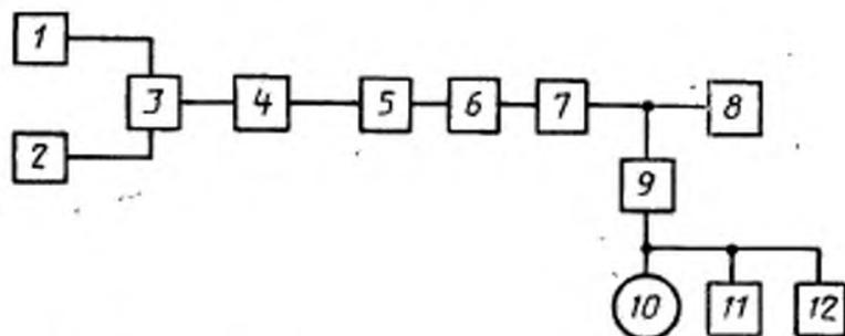
1, 2 — генераторы ГЧН; 3 — суммирующее устройство для сложения сигналов; 4 — цепь предискажений или стереофонический модулятор; 5 — генератор ГСВЧ; 6 — эквиваленту антенны; 7 — радиоприемник; 8 — эквивалент нагрузки; 9 — полосовой фильтр с полосой пропускания на уровне минус 3 дБ от 200 Гц до 15 кГц; 10 — электронный вольтметр переменного тока; 11 — анализатор спектра или селективный вольтметр; 12 — осциллограф
