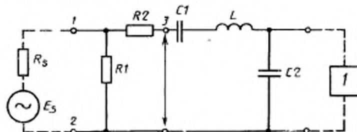
1 — радиоприемник;  $E_s$  — ЭДС источника сигнала;  $R_3$  — номинальное выходное сопротивление источника сигнала;  $R_1$ ,  $R_2$ ,  $C_1$ ,  $C_2$ ,  $L$  — резисторы, конденсаторы и катушка индуктивности соответственно
