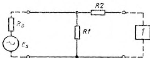
*I* — радиоприемник;  $E_s$  — ЭДС источника сигнала;  $R_s$  — номинальное выходное сопротивление источника сигнала;  $R_1$  — резистор сопротивлением, равным номинальному выходному сопротивлению источника сигнала;  $R_2$  — резистор сопротивлением,
