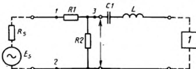
1 — радиоприемник;  $E_s$  — ЭДС источника сигнала;  $R_s$  — номинальное выходное сопротивление источника сигнала;  $R_1$ ,  $R_2$ ,  $C_1$ ,  $L$  — резисторы, конденсатор и катушка индуктивности соответственно
