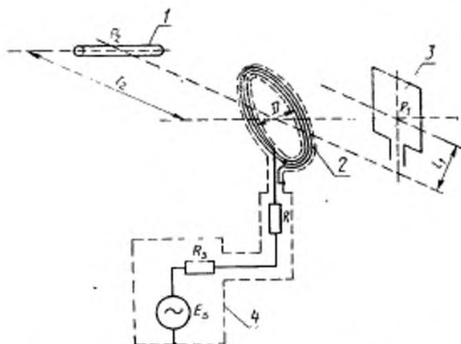
1 — антенна с ферритовым сердечником, 2 — экранированная рамочная антенна; 3 — антенна с воздушным сердечником; 4 — генератор ГСВ1;  $R_2$  — номинальное выходное сопротивление генератора;  $E_3$  — ЭДС генератора;  $R$  — резистор сопротивлением, определяемым из условия  $R_2 + R = 409 \text{ Ом}$ .
