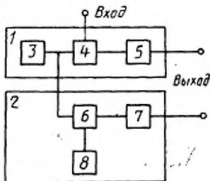
1, 2 — генераторы ГСВТ; 3 — генератор несущей частоты; 4, 6 — модуляторы; 5, 7 — усилители; 8 — генератор частоты 1000 Гц
