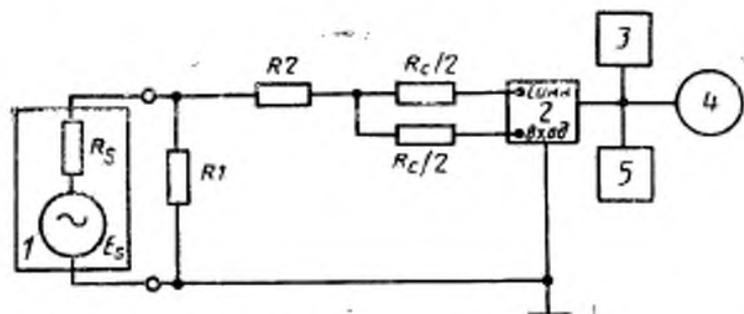
1 — генератор (ГОВ1 или ГОВ2); 2 — радиоприемник; 3 — эквивалент нагрузки; 4 — электронный вольтметр переменного тока; 5 — осциллограф;
