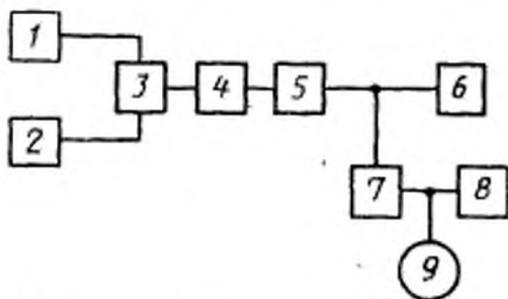
1, 2 — генераторы ГСВ2; 3 — схема смешения сигналов; 4 — эквивалент антенны; 5 — радиоприемник; 6 — эквивалент нагрузки; 7 — полосовой фильтр с полосой пропускания на уровне 3 дБ от 200 Гц до 15 кГц; 8 — осциллограф; 9 — электронный вольтметр переменного тока
