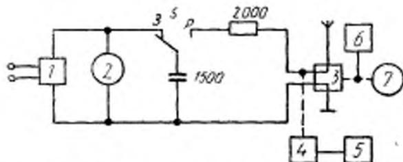
1 — источник постоянного напряжения; 2 — киловольтметр постоянного тока; S — переключатель или реле; 3 — радиоприемник; 4 — эквивалент антенны; 5 — генератор (ГСВ1 или ГСВ2); 6 — осциллограф; 7 — электронный вольтметр переменного тока
