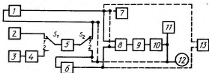
1 — генератор ГСВ1; 2 — генератор ГСН; 3 — генератор шума ГШ; 4 — фильтр для получения взвешенного шума, имитирующего помеху; 5 — фильтр нижних частот; 6 — генератор ГСВ1; 7 — осциллограф; 8 — схема смещения сигналов; 9 — эквивалент антенны; 10 — радиоприемник; 11 — эквивалент нагрузки; 12 — электронный вольтметр переменного тока; 13 — частотомер;  $S_1$ ,  $S_2$  — переключатели
