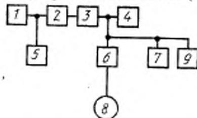
1 — генератор ГСВ2; 2 — эквивалент антенны; 3 — радиоприемник; 4 — эквивалент нагрузки; 5 — частотомер; 6 — полосовой фильтр с полосой пропускания на уровне 3 дБ от 200 Гц до 15 кГц; 7 — осциллограф; 8 — электронный вольтметр переменного тока; 9 — анализатор спектра
