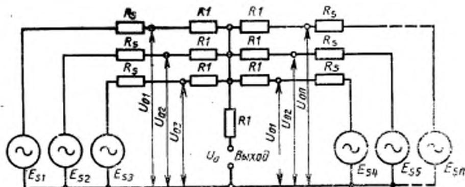
$E_{S1}, \dots, E_{Sn}$  — ЭДС источников сигналов;  $R_{Si}$  — выходное сопротивление источников сигналов;  $R_1$  — резистор сопротивлением, определяемым из условия  $R_1 = \frac{n-1}{n+1} R_{Si}$ , где  $n$  — число источников сигналов, подлежащих смешению
