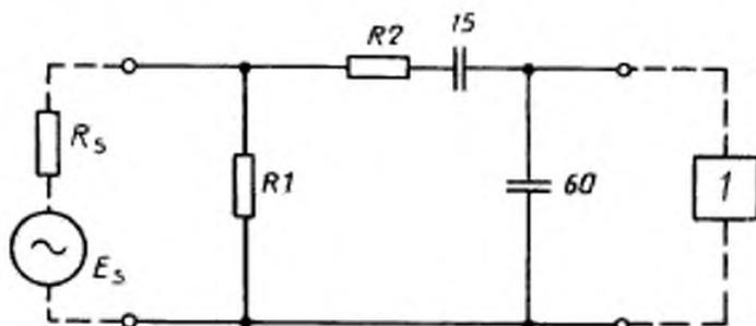
1 — радиоприемник,  $E_s$  — ЭДС источника сигнала;  $R_s$  — номинальное выходное сопротивление источника сигнала;  $R_1$  — резистор сопротивлением, равным номинальному выходному сопротивлению источника сигнала;  $R_2$  — резистор сопротивлением, определяемым из условия  $R_2 = (80 - \frac{R_s}{2})$  Ом
