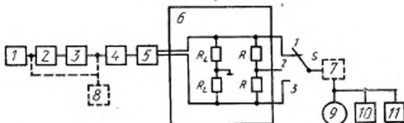
1 — генератор ГСН; 2 — стереофонический модулятор; 3 — генератор ГСВ2; 4 — эквивалент антенны; 5 — радиоприемник; 6 — эквивалент нагрузки; 7 — полосовой фильтр с полосой пропускания на уровне минус 3 дБ от 200 Гц до 15 кГц; 8 — частотомер; 9 — электронный вольтметр переменного тока; 10 — измеритель коэффициента гармоник или анализатор спектра; 11 — осциллограф; S — переключатель; R — симметрирующие резисторы;  $R_L$  — резисторы эквивалента нагрузки;  $R \gg R_L$
