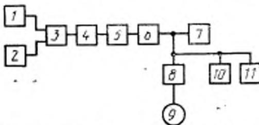
1, 2 — генераторы ГСН; 3 — стереофонический модулятор; 4 — генератор ГСВ2; 5 — эквивалент антенны; 6 — радиоприемник; 7 — эквивалент нагрузки; 8 — полосовой фильтр с полосой пропускания на уровне минус 3 дБ от 200 Гц до 15 кГц; 9 — электронный вольтметр переменного тока; 10 — анализатор спектра или селективный вольтметр; 11 — осциллограф
