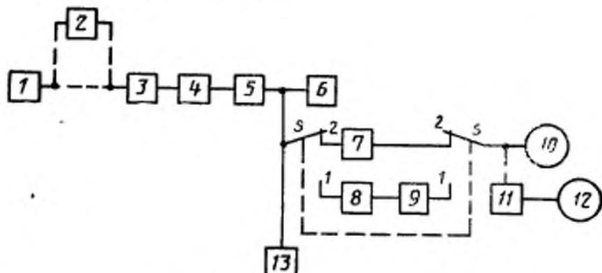
1 — генератор ГСН; 2 — стереофонический модулятор; 3 — генератор ГСВ2; 4 — эквивалент антенны; 5 — радиоприемник; 6 — эквивалент нагрузки; 7 — полосовой фильтр с полосой пропускания на уровне минус 3 дБ от 200 Гц до 15 кГц; 8 — полосовой фильтр с полосой пропускания на уровне минус 3 дБ от 900 до 1300 Гц; 9 — аттенуатор; 10 — электронный вольтметр переменного тока; 11 — взвешивающий фильтр (приложение 3); 12 — измеритель квазипиковых значений (приложение 3); 13 — осциллограф; S — переключатель
