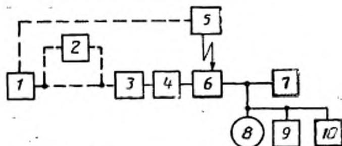
1 — генератор ГСН; 2 — цепь предискажений или стереофонический модулятор; 3 — генератор (ГСВ1) или ГСВ2; 4 — эквивалент антенны; 5 — генератор поля; 6 — радиоприемник; 7 — эквивалент нагрузки; 8 — электронный вольтметр переменного тока; 9 — анализатор спектра; 10 — осциллограф
