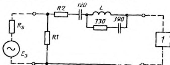
1 — радиоприемник;  $E_s$  — ЭДС источника сигнала;  $R_s$  — номинальное выходное сопротивление источника сигнала;  $R_1$  — резистор сопротивлением, равным номинальному выходному сопротивлению источника сигнала;  $R_2$  — резистор сопротивлением, определяемым из условия  $R_2 = (80 - \frac{R_s}{2})$  Ом;  $L$  — катушка индуктивностью, равной 22 мкГ
