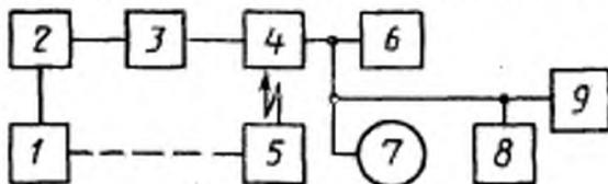
1 — генератор ГСН; 2 — генератор ГСВ1; 3 — эквивалент антенны; 4 — радиоприемник; 5 — генератор поля; 6 — эквивалент нагрузки; 7 — электронный вольтметр переменного тока; 8 — измеритель коэффициента гармоник или анализатор спектра; 9 — осциллограф
