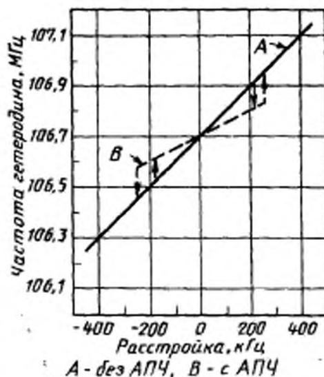
В обоих случаях отдельно проверяют работу АПЧ. Во время проведения последующих измерений частоты высокочастотный входной сигнал на вход радиоприемника не подают. Нажимают первую выбранную кнопку настройки радиоприемника. Измеряют частоту гетеродина  $f_{г0}$ , соответствующую рабочей частоте, и используют ее как опорную для этой серии измерений.
