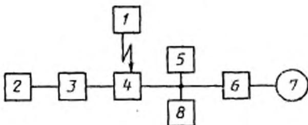
1 — генератор поля; 2 — генератор шума ГШ; 3 — эквивалент антенны; 4 — радиоприемник; 5 — эквивалент нагрузки; 6 — полосовой фильтр с полосой пропускания на уровне минус 3 дБ от 22,4 Гц до 22,4 кГц; 7 — электронный вольтметр переменного тока; 8 — осциллограф
