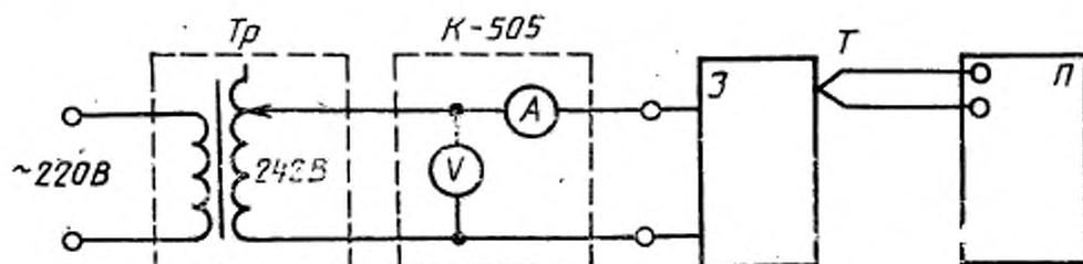
Tr — регулятор напряжения РНО; З — испытываемый звонок; Л — автоматический потенциометр КСП-4; T — термоэлектрический преобразователь ТХА
