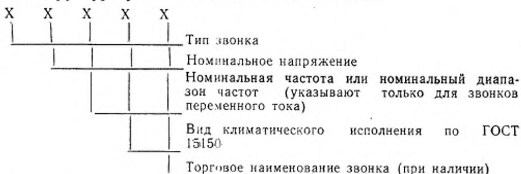
Пример условного обозначения электрического бытового звонка мелодичного боя с напряжением, подаваемым на кнопку, св. 42 В, номинальным напряжением 220 В, частотой 50 Гц, вида климатического исполнения УХЛ4.2, торгового наименования «Сигнал»:
