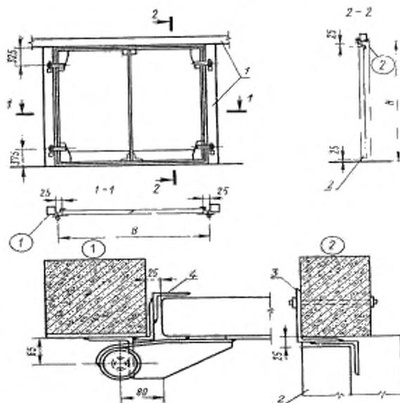
1 — доски настила, 2 — поперечные планки, 3 — подкладки, 4 — строительные гвозди К2,5/50 по ГОСТ 4028; 5 — строительные гвозди К3,5/90 по ГОСТ 4028; 6 — накладка
