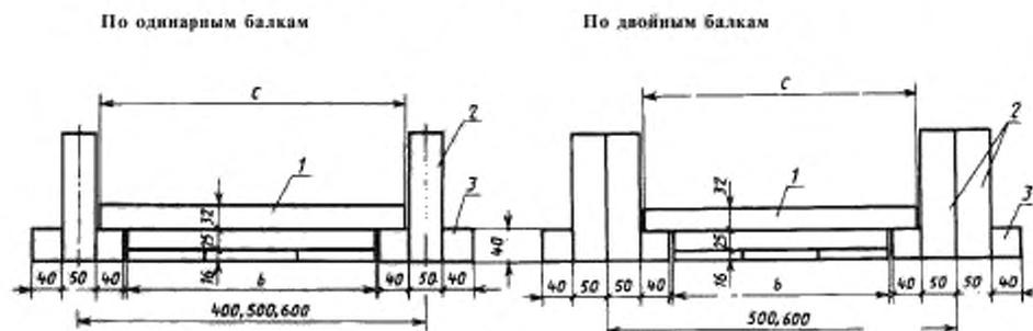
1 - плит перекрытия; 2 - балки перекрытия; 3 - черновой брус.
